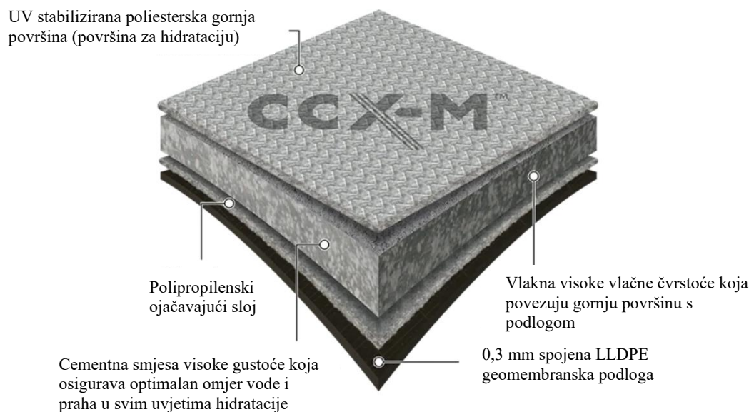
Slika 2. Shematski prikaz poprečnog presjeka geokompozita CCX-M
