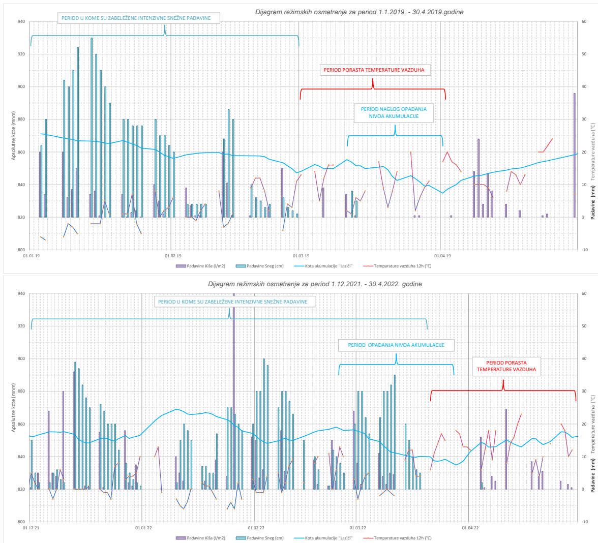
Slika 4. Dijagrami režimskih opažanja za razdoblje neposredno prije aktivacije klizišta (2019. god.) i sličan period 2021./2022. godine
