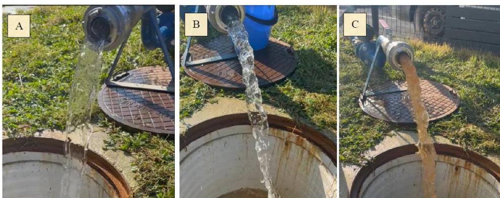
Slika 1. Otvoreni izljev vode iz primarnog kruga zemne vode radi praćenja kvalitete vode sukladno crpnom režimu. Na slici „A“ pri protoku od 0,9 l/s voda je visoke bistroće, na slici „B“ pri protoku od 2,5 l/s voda je smanjene bistroće, na slici „C“ kod protoka 3,5 l/s voda je замуćena.
