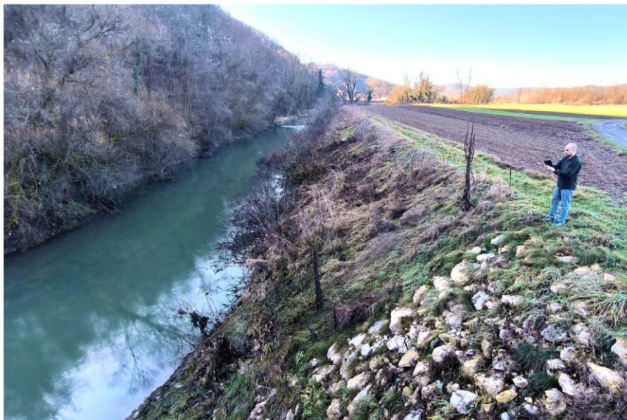
Slika 3. Mjerenje površinske brzine korištenjem mobilnog telefona (Šamanović et al, 2026)
