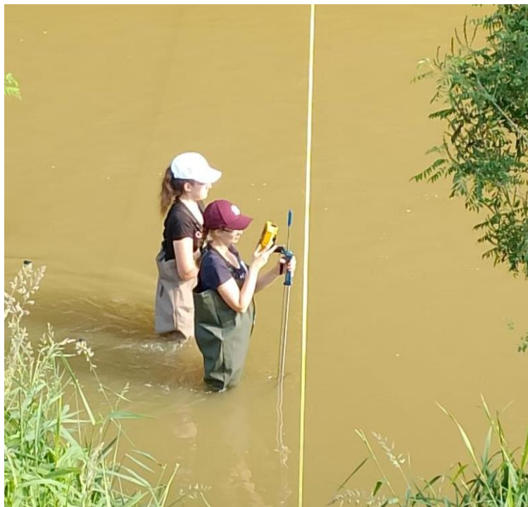
Slika 1. Primjer mjerenja hidroloških veličina ADV-om
