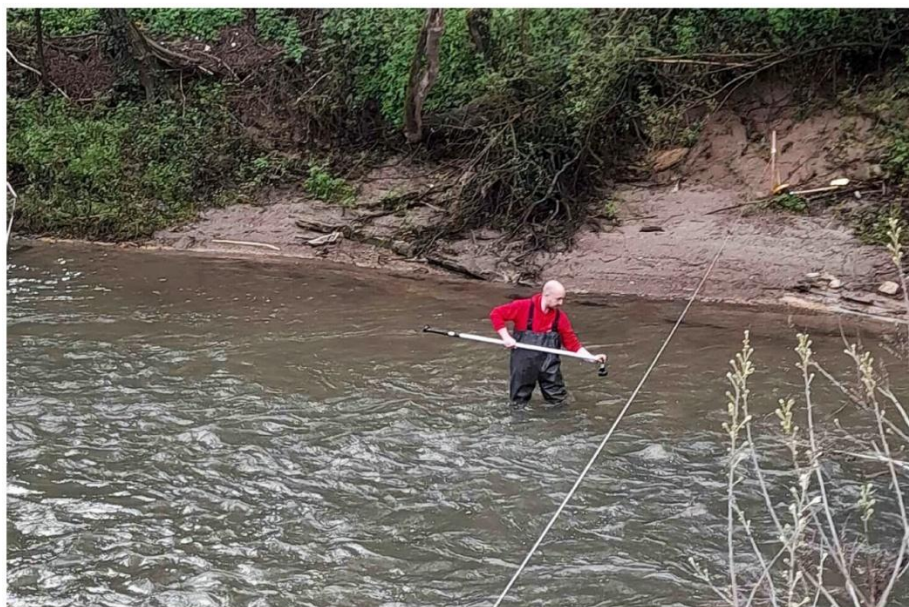
Slika 2. Primjer mjerenja hidroloških veličina hidrometrijskim krilom (Šamanović et al, 2026)
