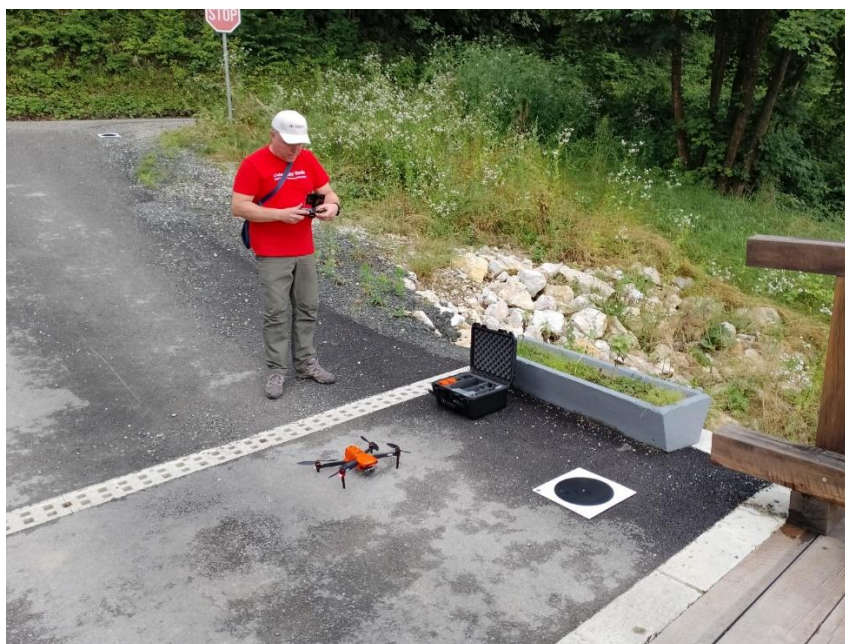
Slika 6. Primjer mjerenja prostornih veličina bespilotnom letjelicom (Šamanović et al, 2026)
