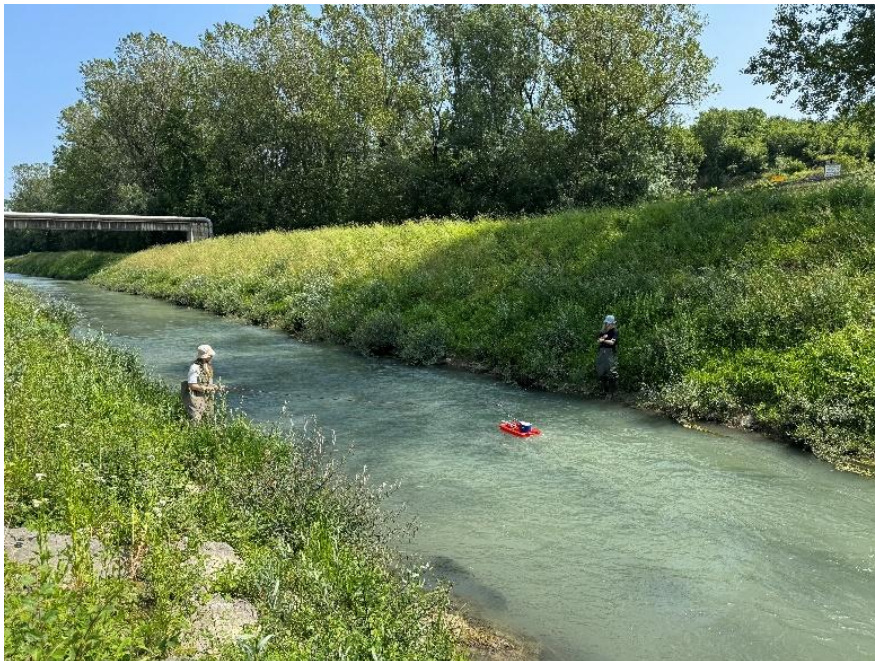
Slika 3. Mjerenje ADCP-om „StreamPro“ na lokaciji Portonski most
