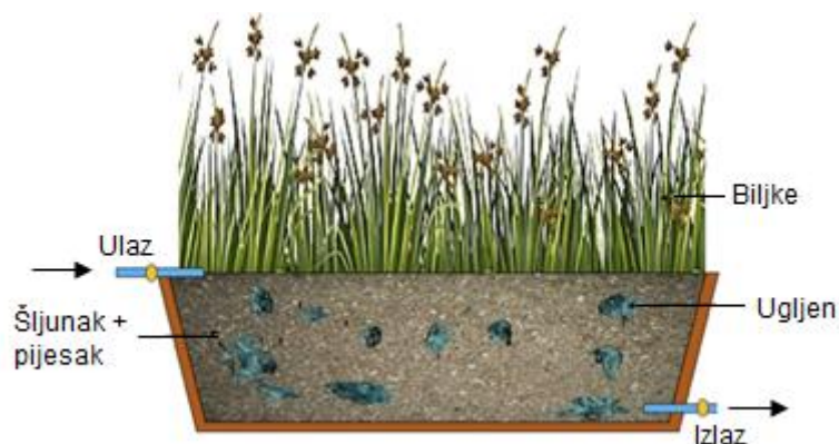
Slika 4. Prikaz sustava biljnog uređaja s višekomponentnim slojem (Karungamye, 2024)
