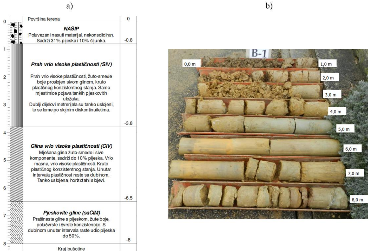
Slika 4. Rezultati istražnog bušenja bušotine B-1: a) sondažni profil; b) fotodokumentacija nabušene jezgre.
